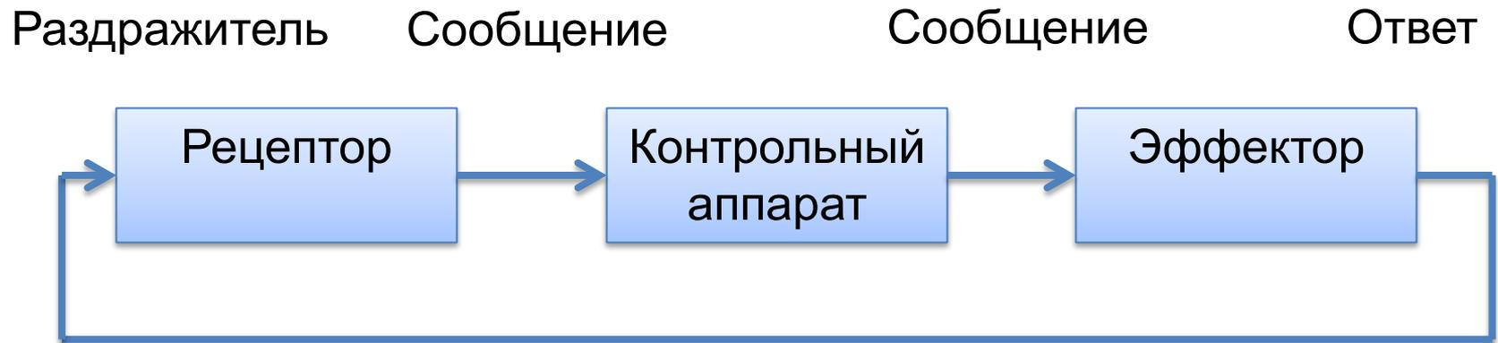
**Отрицательная обратная связь** - это такое воздействие выхода системы на ее вход, которое уменьшает воздействие входного сигнала на систему.
