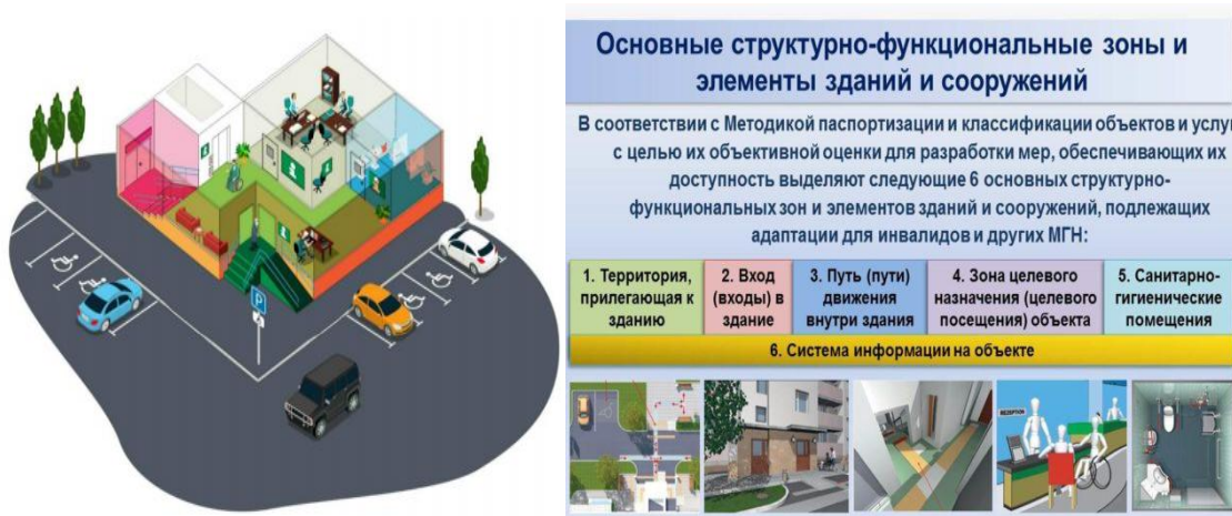
Рисунок 4 - Основные структурно-функциональные зоны и элементы зданий и сооружений, подлежащие адаптации для инвалидов и других МГН[15]
